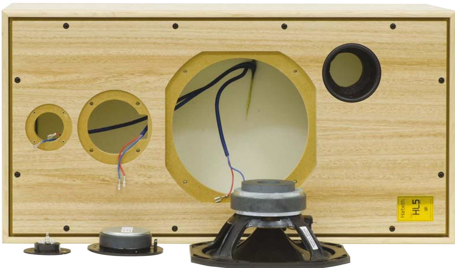
Gli altoparlanti rimossi dal pannello frontale. Il woofer ha la membrana in copolimero ed il doppio anello magnetico esterno. Il condotto di accordo presenta sulla terminazione interna un anello di materiale assorbente per ridurre l'innesco di spurie.
