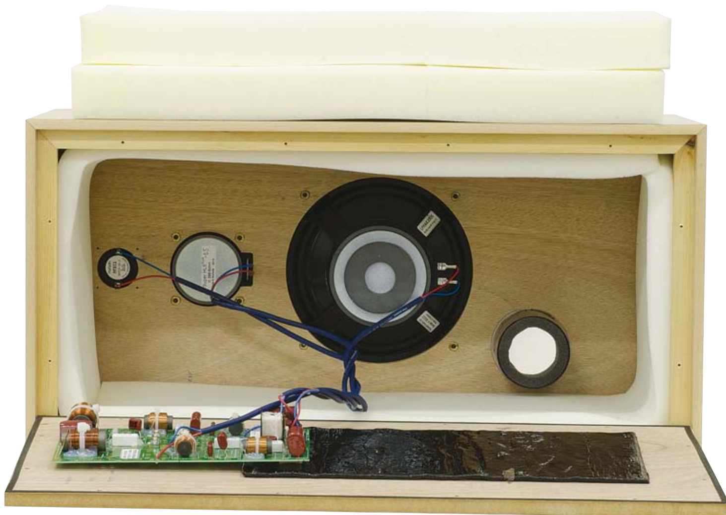
L'interno del diffusore col pannello posteriore rimosso. Si notano le madreviti per il tweeter ed il woofer, mentre il supertweeter, viste le dimensioni, utilizza viti dalla filettatura rada. Il "tappeto" nero sotto al filtro è in effetti un impasto di cellulosa e catrame che ricopre anche le pareti laterali.
